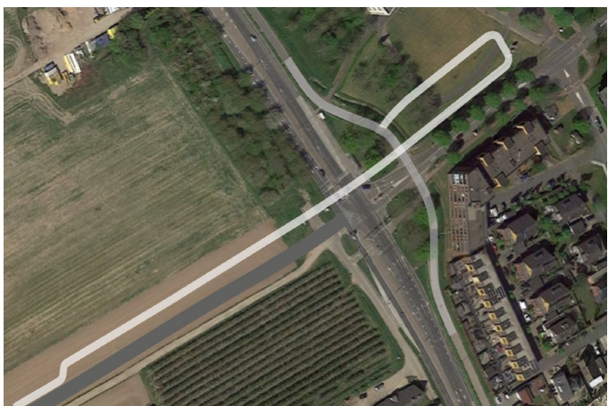
Benodigde inpassing van hellingbanen bij verbinding over de N229 bij bestaande kruispunten
